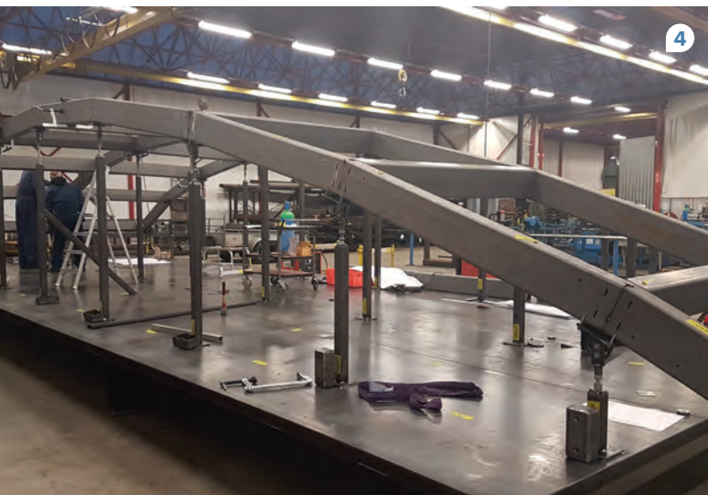
1 // De kokers zijn file-to-factory vanuit het gridshellprogramma op maat gemaakt met een robotkop. 2 // Op de staanders zit een instelbare kop, die in alle richtingen gepositioneerd kan worden voor de ondersteuning onder de juiste hoek. 3 // Rond het centrale asje op de mal worden de digitaal gesneden kokers gelast. 4 // Voor het lassen is een instelbare mal gemaakt met staanders onder elk te lassen knooppunt.
